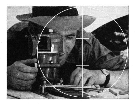
RK — Modernste Messtischausrüstung für topographische Arbeiten / stabile Tischaufstellung durch eingebauten Messtischkopf mit Kugelgelenk / neuartige Kippregel mit bequemem, festem Okulareinblick / aufrechtes Fernrohrbild / selbstreduzierende Distanzmesseinrichtung/direkte Ablesung der Höhendifferenz / Feinstellvorrichtung auch für die Richtungsmessung / Punktauftrag mit Linealpiquoir ohne Stechzirkel und Transversalmassstab. Verlangen Sie den ausführlichen Prospekt.
