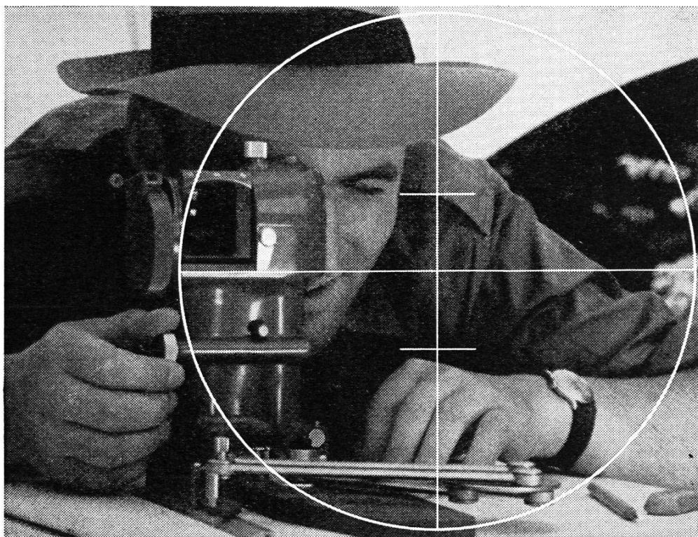
RK — Modernste Messtischausstattung für topographische Arbeiten / stabile Tischaufstellung durch eingebauten Messtischkopf mit Kugelgelenk / neuartige Kippregel mit bequemem, festem Okulareinblick / aufrechtes Fernrohrbild / selbstreduzierende Distanzmesseinrichtung/direkte Ablesung der Höhendifferenz/ Feinstellvorrichtung auch für die Richtungsmessung / Punktauftrag mit Linealpliquoir ohne Steczirkel und Transversalmassstab.
