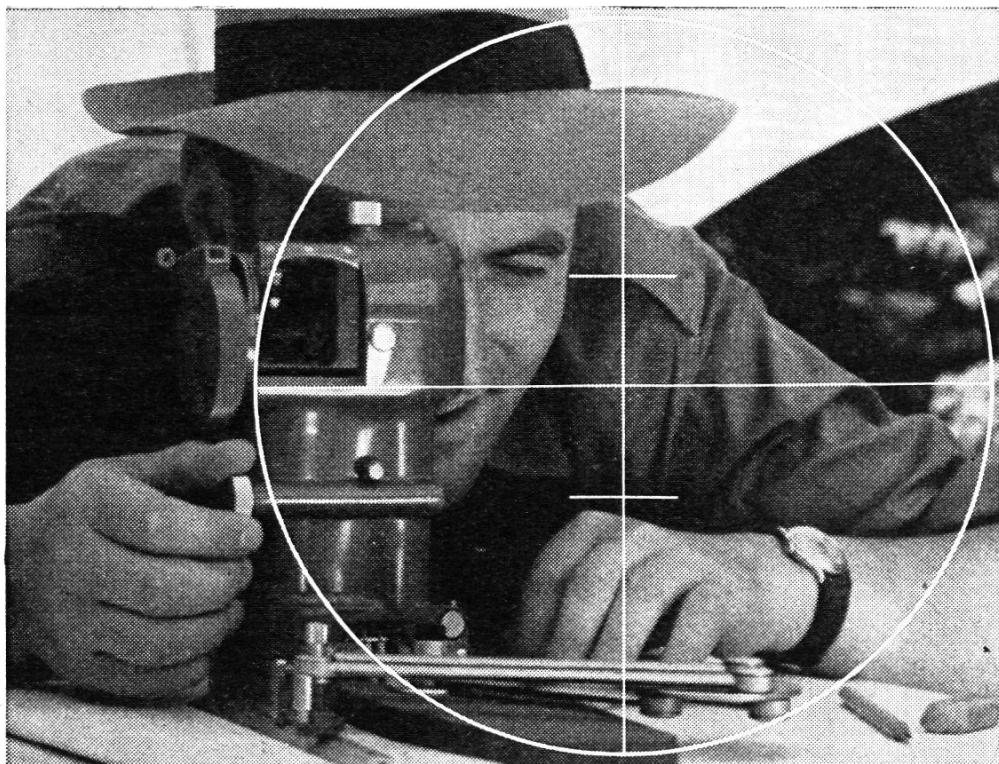
RK — Modernste Messtischausstattung für topographische Arbeiten / stabile Tischaufstellung durch eingebauten Messtischkopf mit Kugelgelenk / neuartige Kippregel mit bequemem, festem Okulareinblick / aufrechtes Fernrohrbild / selbstreduzierende Distanzmesseinrichtung/direkte Ablesung der Höhendifferenz/ Feinstellvorrichtung auch für die Richtungsmessung / PunktAuftrag mit Linealpiquoir ohne Stechzirkel und Transversalmassstab.
