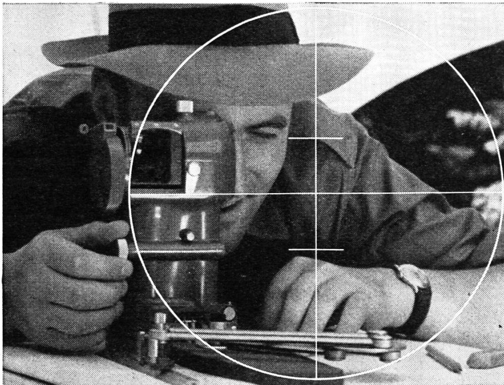
**RK** — Modernste Messtischausrüstung für topographische Arbeiten / stabile Tischaufstellung durch eingebauten Messtischkopf mit Kugelgelenk / neuartige Kippregel mit bequemem, festem Okulareinblick / aufrechtes Fernrohrbild / selbstreduzierende Distanzmesseinrichtung / direkte Ablesung der Höhendifferenz / Feinstellvorrichtung auch für die Richtungsmessung / Punktauftrag mit Linealpiquoir ohne Stechzirkel und Transversalmassstab.
