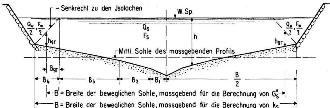
d) Beziehung zwischen Wassertiefe  $h$ , Wassermenge  $Q$  und Geschiebemenge  $G''_s$
