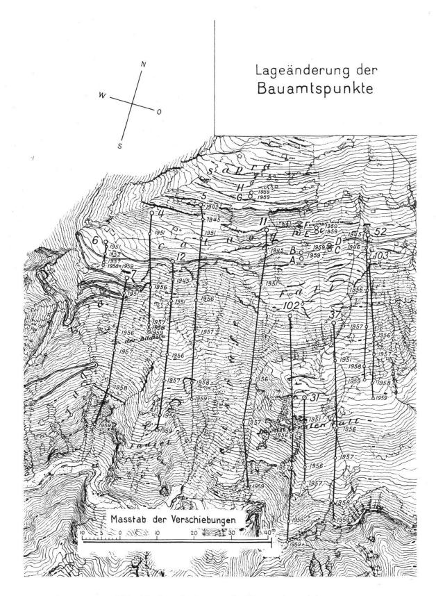
Abb. 11. Lageänderung der Bauamtspunkte. Maßstab der Karte etwa 1:10000.
