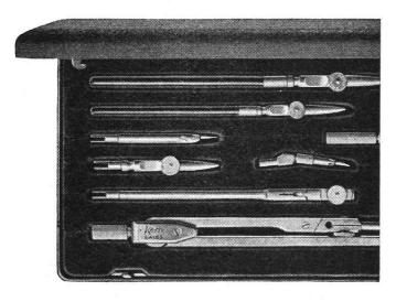
\*Kern-Präzisionsreisszeuge Serie A sind aus hartgewalztem Neusilber hergestellt und zusätzlich hartverchromt. Hartchrom ist härter als Stahl, läuft nicht an, rostet nie und gibt den Zeicheninstrumenten höchste Verschleissfestigkeit.
