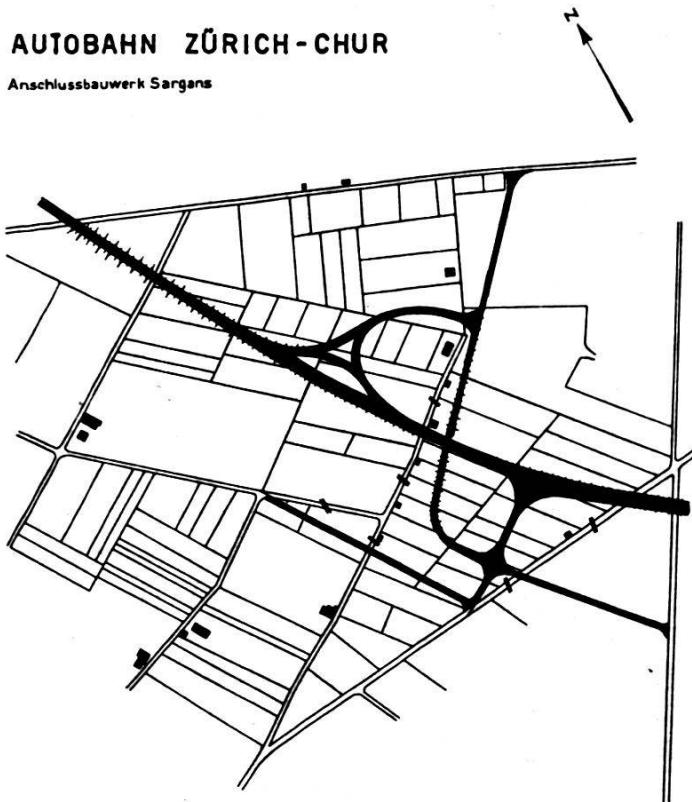
Das Plänen zeigt deutlich, wie ein Anschlußbauwerk in einem Gebiet mit einigermaßen regelmäßigen Grundstücksformen einer neuen Einteilung ruft. Innerhalb der Schleifen kann nunmehr ein einziger Eigentümer zugeteilt werden. Bestehende Wege müssen zum Teil aufgehoben und urbarisiert werden; zum Teil sind neue Flurwege anzulegen.
