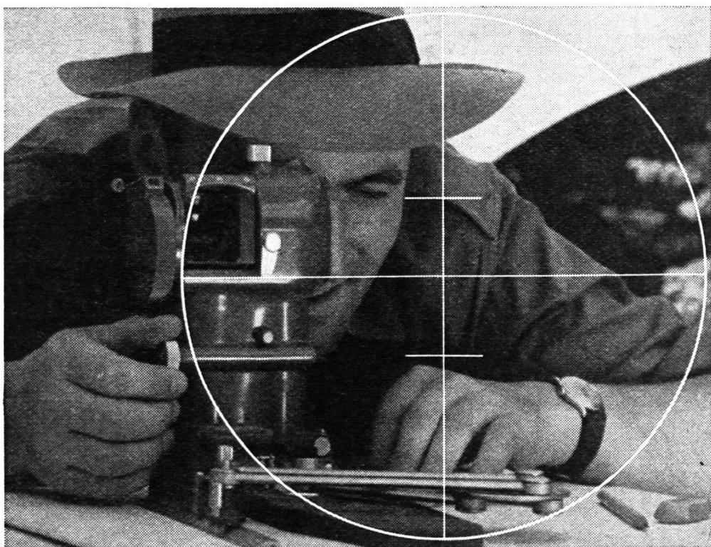
RK — Modernste Messtischausstattung für topographische Arbeiten / stabile Tischaufstellung durch eingebauten Messtischkopf mit Kugelgelenk / neuartige Kippregel mit bequemem, festem Okulareinblick / aufrechtes Fernrohrbild / selbstreduzierende Distanzmesseinrichtung/direkte Ablesung der Höhendifferenz/ Feinstellvorrichtung auch für die Richtungsmessung / Punktauftrag mit Linealpiqueoir ohne Steczirkel und Transversalmaßstab.
