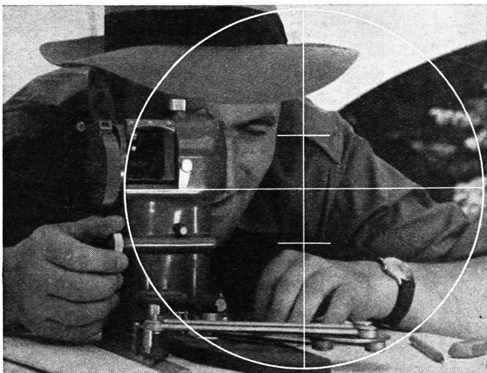
RK — Modernste Messtischausstattung für topographische Arbeiten / stabile Tischaufstellung durch eingebauten Messtischkopf mit Kugelgelenk / neuartige Kippregel mit bequemem, festem Okulareinblick / aufrechtes Fernrohrbild / selbstreduzierende Distanzmesseinrichtung/direkte Ablesung der Höhendifferenz/ Feinstellvorrichtung auch für die Richtungsmessung / Punktauftrag mit Linealpiquois ohne Steczirkel und Transversalmaßstab.
