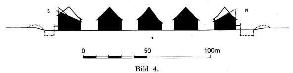
Schematischer Querschnitt von Süden (links) nach Norden. Die Proportionen der Straßenräume sind ungestört erhalten geblieben. An die Stelle der früheren Pultdächer längs der inneren Stadtmauer sind Satteldächer getreten, die äußere Stadtmauer ist fast ganz verschwunden. Wall und Graben sind nur noch schwach erkennbar. Das sogenannte Zwinghofgebiet zwischen innerer und äußerer Stadtmauer ist teilweise überbaut worden.
