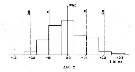
von den 59 einzelnen Fehlern 66,2% innerhalb des einfachen (theoretisch 68,3%), 98,4% (95,5%) innerhalb des doppelten und 100% (99,7%) innerhalb des dreifachen mittleren Fehlers.
