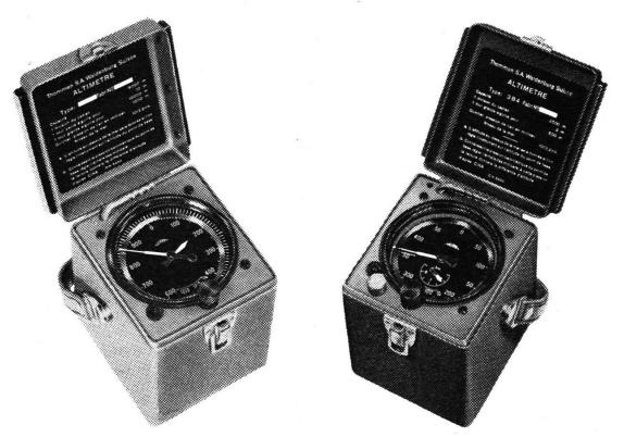
Typ  $3\,\mathrm{B}\,1$  (Meßbereich  $-500\,\mathrm{bis} + 5000\,\mathrm{m}$  Typ  $3\,\mathrm{B}\,4$  Meßbereich  $-500\,\mathrm{bis} + 2500\,\mathrm{m}$  Abb. 1. Präzisionsbodenhöhenmesser
