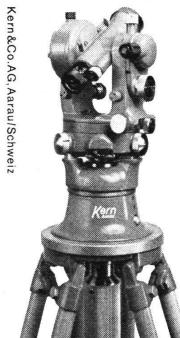
DKM 1 der kleine Doppelkreis-Triangulationstheodolit mit erstaunlicher Genauigkeit. Rascher Einsatz durch das Zentrierstativ — zuverlässige Messungen durch diametral gemittelte Kreisablesung — spart Platz und Gewicht beim Transport.
