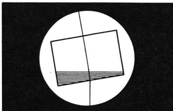
Verblüffend einfache Lösung der Automatik: Flüssigkeitsprisma ohne mechanische Teile, ohne Abnutzung, ohne Störungen, ohne Reparaturen.
