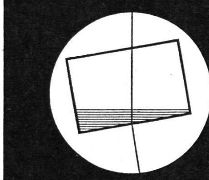
Verblüffend einfache Lösung der Automatik: Flüssigkeitsprisma ohne mechanische Teile, ohne Abnutzung, ohne Störungen, ohne Reparaturen.
