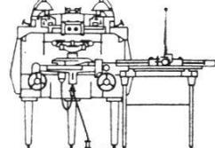
registriert acht Kennziffern, die Modellkoordinaten X Y auf 1/100 mm und Z mit Hundertstelmillimeter Modellgenauigkeit direkt in Metern oder englischen Fuß
