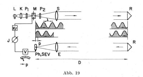
polarisierte Modulationswelle mittels des Senderobjektives S auf den entfernten Reflektor R geworfen zu werden. Dieser reflektiert das Licht zum Empfänger E zurück, der es auf die Photokathode der Photozelle Ph sammelt. Dem Kristalloszillator Kr fällt die Aufgabe zu, die Frequenz des Modulators konstant zu halten. Mit dem Verzögerer V wird elektronisch die durch den SEV erzeugte elektrische Schwingung verzögert, bis der Phasenindikator J durch Vergleich der Schwingung der Kerrzellen-
