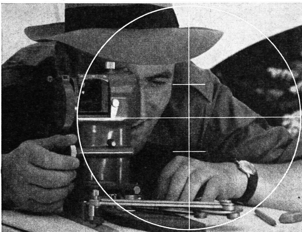
RK — Modernste Messtischausstattung für topographische Arbeiten / stabile Tischaufstellung durch eingebauten Messtischkopf mit Kugelgelenk / neuartige Kippregel mit bequemem, festem Okulareinblick / aufrechtes Fernrohrbild / selbstreduzierende Distanzmesseinrichtung/direkte Ablesung der Höhendifferenz / Feinstellvorrichtung auch für die Richtungsmessung / Punktauftrag mit Linealpliquoir ohne Stechzirkel und Transversalmassstab.
