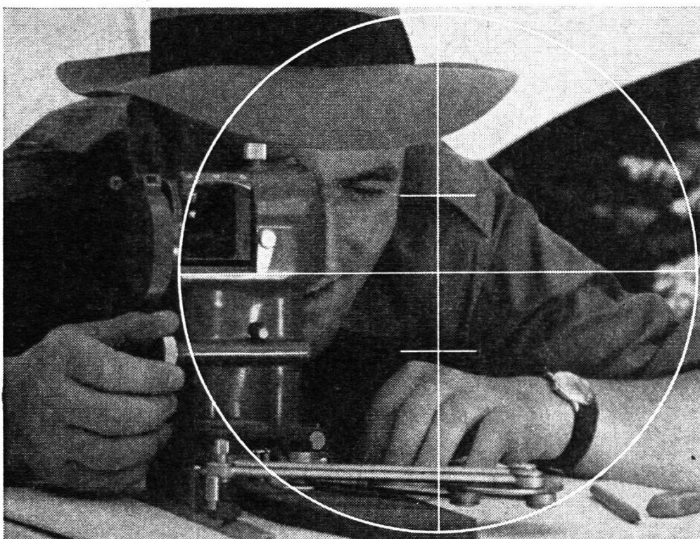
RK — Modernste Messtischausstattung für topographische Arbeiten / stabile Tischaufstellung durch eingebauten Messstischkopf mit Kugelgelenk / neuartige Kippregel mit bequemem, festem Okulareinblick / aufrechtes Fernrohrbild / selbstreduzierende Distanzmesseinrichtung/direkte Ablesung der Höhendifferenz / Feinstellvorrichtung auch für die Richtungsmessung / Punktauftrag mit Linealpliquoir ohne Stechzirkel und Transversalmassstab.
