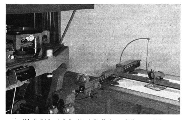
Abb. 3. Zeichentisch des A7 mit Profiloskop und Diagrammplatte
