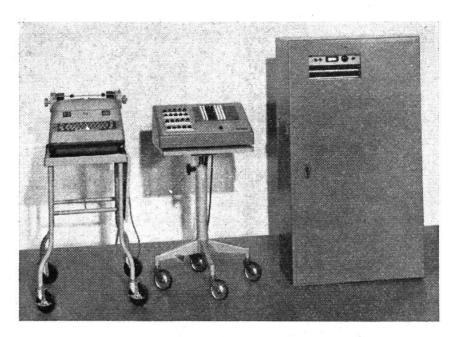
Abb. 2. Elektrisches Koordinatenregistriergerät EK3 für die Registrierung von Autographenkoordinaten und Querprofildaten in Klarschrift und auf Lochstreifen, Lochkarten oder Magnetband
