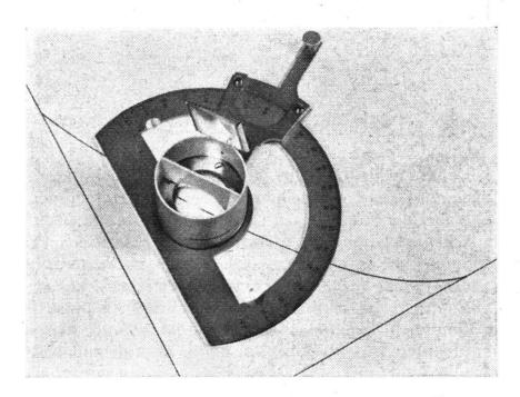
Abb. 6. Derivimeter von A. Ott, Kempten, mit dem die Richtung der Normalen auf beliebige Kurven rasch und sicher ermittelt werden kann
