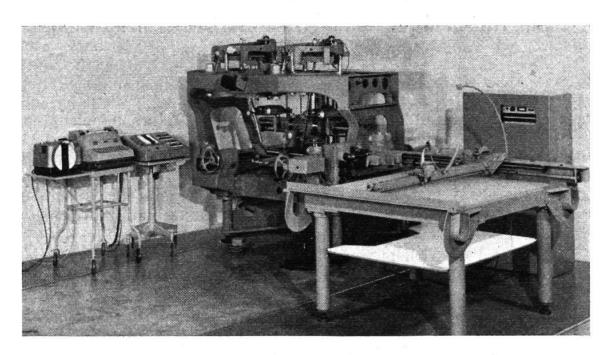
Abb. 1. Autograph Wild A7 mit elektrischem Registriergerät EK3
