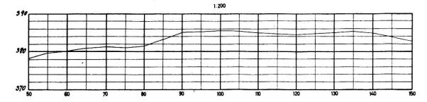
Abb. 7. Nach Diktat aufgetragenes photogrammetrisch ermitteltes Querprofil
