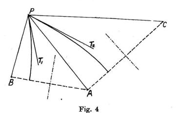
La Figure 4 est un schéma; un récepteur est à bord de l'aéronef en P. Les stations A (maîtresse), B et C (asservies), émettent des impulsions synchronisées sur onde modulée (Loran). Les longueurs PA, PB, PC étant inégales on enregistre au récepteur des différences de temps.
