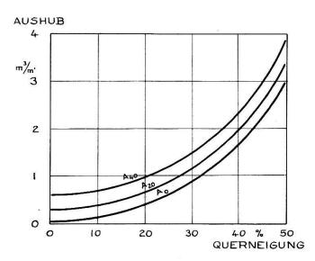
Abb. 3. Aushub pro Laufmeter bei Massenausgleich als Funktion der Querneigung des Geländes bei einem definierten Normalprofil. Bekiesungsbreite 350 cm. Bankettbreite beidseitig je 30 cm. Die Kurve  $A_0$  bezieht sich auf einen Weg, dessen Achse der Geländeoberfläche derart folgt, daß an jeder Stelle Massenausgleich vorhanden ist. Die Kurven  $A_{20}$  und  $A_{40}$  gelten für Wege, deren Achse im Mittel 20 cm beziehungsweise 40 cm von jener ideellen Lage abweichen.
