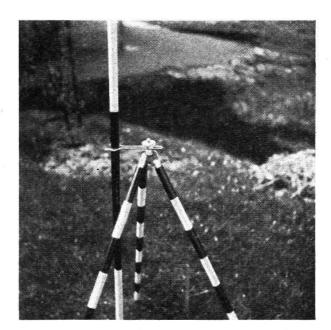
Fig. 6. Jalon mit Stativkopf
