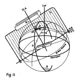
(Fig. 11) Dieses Hilfsmittel ist eine Reiterlibelle (R.L.) oder eine Alhidadenlibelle (A.L.), die beide in der zur Beobachtungsebene B in guter Näherung senkrechten Libellenebene L wirken und mit denen somit die Winkelgröße  $\nu'$  gemessen werden kann. (Schluß folgt.)
