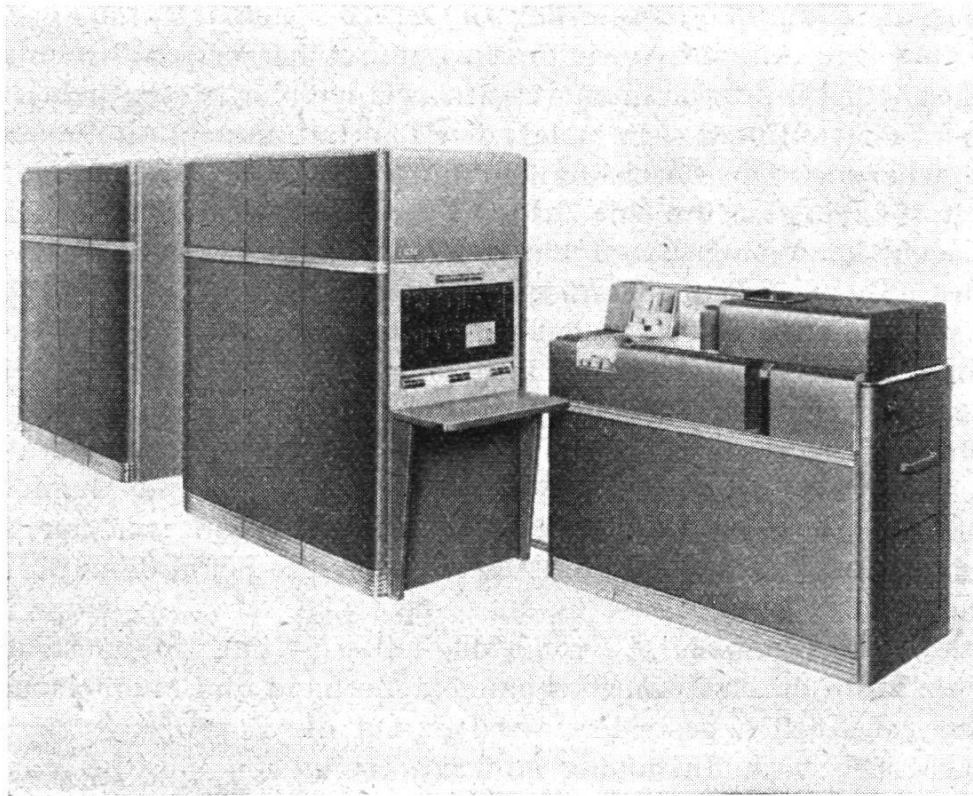
Abb. 2. Die IBM 650 als Beispiel einer mittelgroßen Rechanlage. Mit über 800 im Betrieb stehenden Exemplaren ist dies der am weitesten verbreitete Typ
