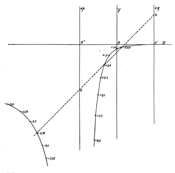
Il y a un point d'inflexion en O', un point de rebroussement de première espèce à l'infini sur l'axe des p et une seconde asymptote 2 D Y = X - 5D.
