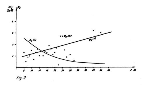
b) Nun werden die Gewichte  $p\Delta$  der Festpunktstrecken bestimmt. Der Ansatz mit den später zu bestimmenden Konstanten  $\omega$  und  $\Omega$
