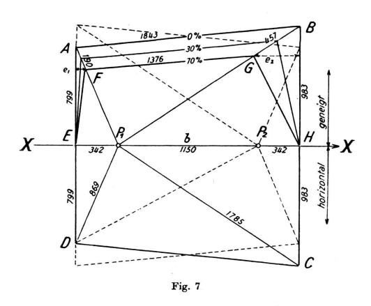
Die Figur 7 stellt die in diesem Fall ungleichseitige Pyramide  $P_1$  dar. Die Hangfläche E F G H schneidet sich mit der Pyramidenfläche  $A B P_1$  in der Linie F G. Letztere schneidet sich mit der Grundlinie A B im gleichen Punkt auf der x-Achse. Die Verkürzung des Bildes längs der Schnittlinie ist links  $(e_1)$  und rechts  $(e_2)$  ungleich.
