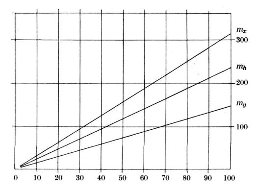
Diagramm 1. Mittlere Fehler der x-y-Koordinaten und der Höhen von Modellpunkten einer Aerotriangulation infolge der Fehler der gegenseitigen und absoluten Orientierung des ersten Modelles. Mittlere Gewichtseinheitsfehler der Parallaxenmessungen und Koordinateneinstellungen = 1. Weitwinkelaufnahmen und 60% Überdeckung.
