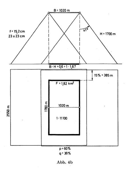
genz. Wenn man also Film zuläßt, ist dank der Aviogon-Kammer  $23 \times 23$  cm die Verwendung einer Doppelkammer f = 21 cm für das Format  $18 \times 18$  cm kaum erwägenswert.
