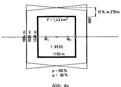
an. Den Überlappungsstreifen wählte ich mit 270 m. In den Winkelpunkten entsteht der Bildmaßstab 1:9520. Die Bildmaßstäbe an den Rändern der Konvergentaufnahmen sind in Abb. 5 dargestellt.
