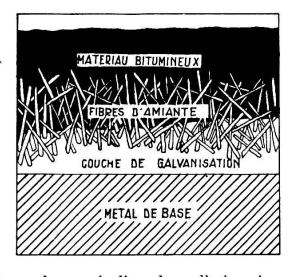
Coupe des parois d'une buse d'acier «Armco»
