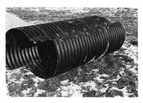
Elément monté d'une canalisation; diamètre: 80 cm, longueur: 1,50 m
