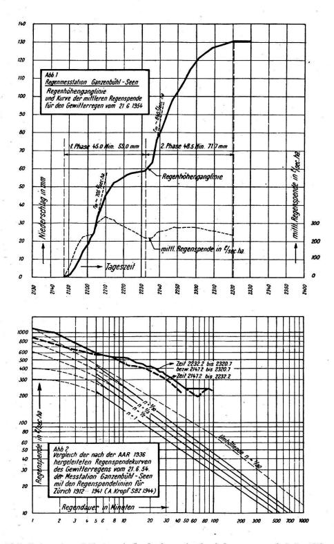
zum Abhebern benötigt wird, keine Aufzeichnung erfolgt. Diese Abheberzeit beträgt im Mittel ca. 0,5 Minuten. Beim Messer mit Stundenwerk erfolgten in 93,5 Minuten 30 Entleerungen gegenüber nur 11 Entleerungen beim Messer mit Tageswerk. Die Verbesserung der Regenhöhen erfolgte dadurch, daß der mittleren Intensität der vorangehenden und nachfolgenden Aufzeichnung entsprechende Korrekturen eingeführt wurden.
