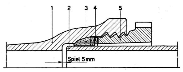
Fig. 2. Elektrisch nicht leitende Schraubmuffenverbindung mit Gleitring 1 Muffenende, 2 Spitzende, 3 Gummidichtung, 4 Gleitring, 5 Schraubring
