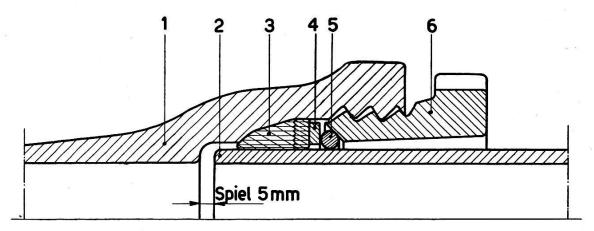
Fig. 3. Elektrisch leitende Schraubmuffenverbindung mit Überbrückung System RYF
