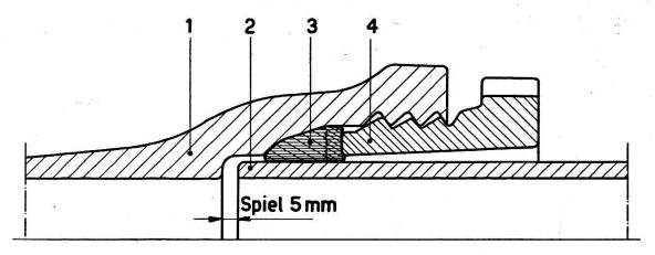
Fig. 1. Elektrisch nicht leitende Schraubmuffenverbindung 1 Muffenende, 2 Spitzende, 3 Gummidichtung, 4 Schraubring
