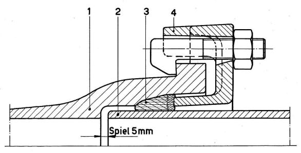
Fig. 4. Gummidichtungsmuffe mit Anpreßring 1 Muffenende, 2 Spitzende, 3 Gummidichtung, 4 Anpreßring
