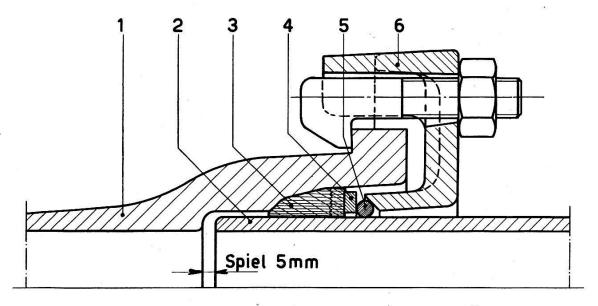
Fig. 5. Gummidichtungsmuffe mit Anpreßring und elektrischer Überbrückung System RYF
