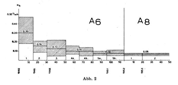
Die Abb. 2 zeigt, daß die Höhengenauigkeit tatsächlich einem guten Gerät erster Ordnung gleichkommt. Auch die Streuung der Resultate ist gering, die Fabrikation als recht gleichmäßig; daher sind auch alle A8 für die praktische Arbeit als gleichwertig anzusehen.
