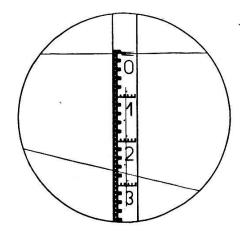
Abb. 1. Der horizontale Strich ist mit der Höhenfeinstellschraube auf die Keilmarke eingestellt.
