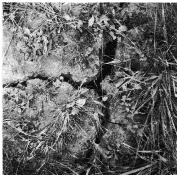
Fig. 6. Schwertriß von oben nach unten, entstandener Schwindriß links
