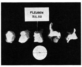
Fig. 7. Gipsabgüsse von Molegängen. Unten: Sollquerschnitt
