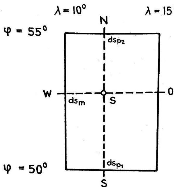
die für die Randlinien des Feldes geltenden Undulationsbeträge  $S$ ,  $W$ ,  $N$ ,  $O$  abliest. Nach der Grundformel für das astronomische Nivellement gilt nun für die relative Geoiderhebung, wenn man im nordöstlichen Azimut vorwärtsschreitet:
