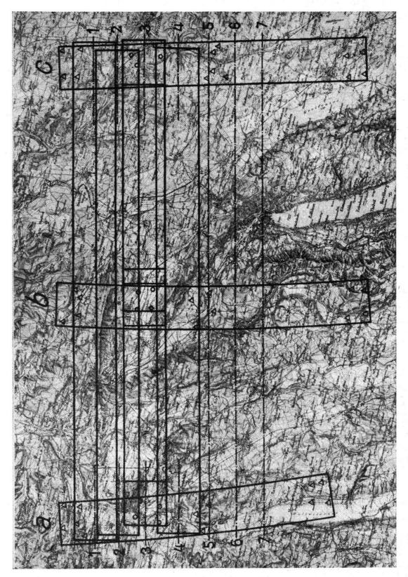
Disposition der Fluglinien zur Bestimmung eines Punktnetzes mittels Blockausgleichung (Die geodätisch gegebenen Punkte sind durch kleine Dreiecke bezeichnet)
