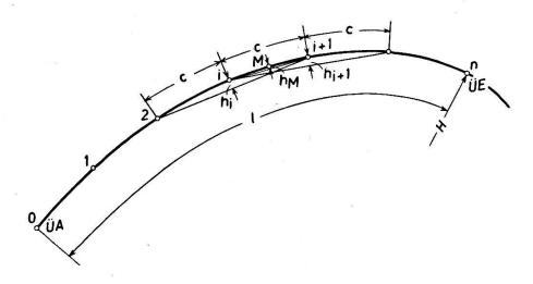
Wenn ein Übergangsbogen (Klotoide) in n gleiche Teile je von der Länge c geteilt ist (Bild) und man die Teilpunkte bei UA, mit Null beginnend, fortlaufend benummert und den Krümmungshalbmesser bei n mit H bezeichnet, so gilt bekanntlich für die Pfeilhöhe für die Sehnenlänge  $s=2\cdot c$  an einem beliebigen Teilpunkt i:
