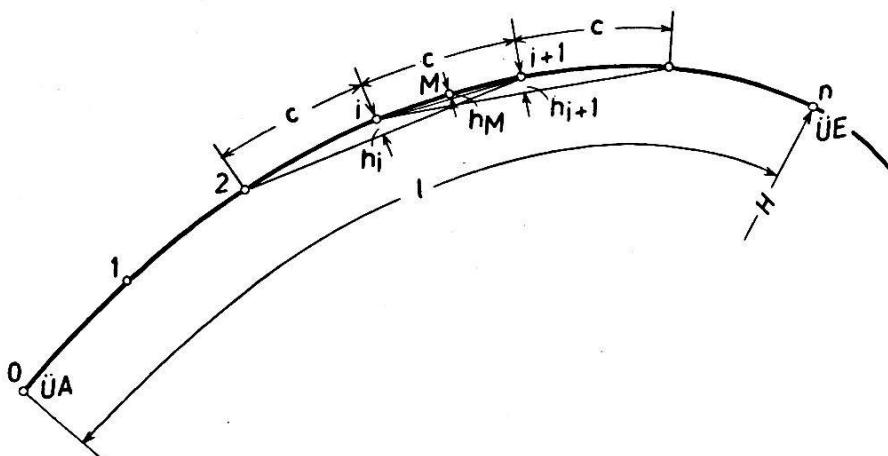
Wenn ein Übergangsbogen (Klotoide) in  $n$  gleiche Teile je von der Länge  $c$  geteilt ist (Bild) und man die Teilpunkte bei  $\dot{U}A$ , mit Null beginnend, fortlaufend benummert und den Krümmungshalbmesser bei  $n$  mit  $H$  bezeichnet, so gilt bekanntlich für die Pfeilhöhe für die Sehnenlänge  $s = 2 \cdot c$  an einem beliebigen Teilpunkt  $i$ :
