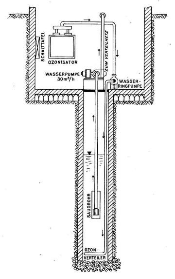
durch seinen verhältnismäßig kleinen Raumbedarf. Der im Pumpwerk eingerichtete Ozonisator besteht aus 3 in einem Blechkasten eingebauten Aggregaten. Die vom Apparat erzeugte ozonisierte Luft wird mit Hilfe einer Wasserringpumpe in den Schachtbrunnen geleitet, wo eine intensive Begasung des Wassers stattfindet.
