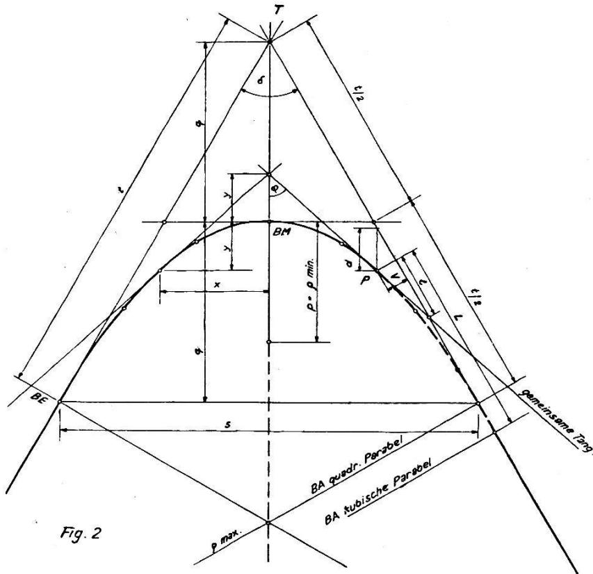
Vorgängig der Ausführung der unter 1–9 erwähnten Arbeiten ist es angezeigt, folgende Überlegung zu machen: Außer vom Tangentenwinkel sind sowohl der maximale als der minimale Krümmungsradius auch von  $p$  und damit von  $q$  und  $t$  abhängig. Je größer  $q$ , um so größer werden  $p$  und  $t$ . Man wird also bei der unter Ziffer 3 erwähnten Wahl von  $q$  dieses so groß als möglich machen.
