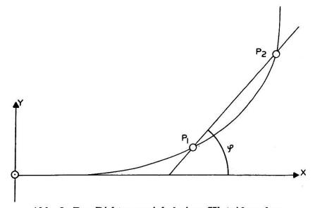
Abb. 2. Der Richtungswinkel einer Klotoidensehne
