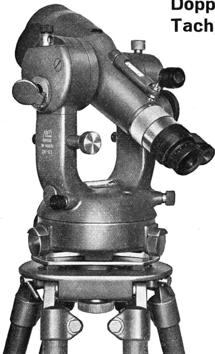
leichter Präzisions-Tachymeter, besonders geeignet für Katastervermessungen nach der Polarkoordinaten-Methode.
