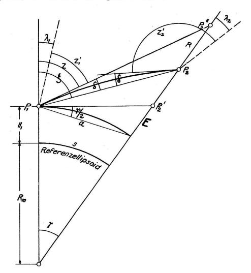
Der Höhenunterschied h kann zerlegt werden in das durch den auf  $P_1$  gemessenen Höhenwinkel  $90^{9}-z$  aus dem Lot des Punktes  $P_2$  herausgeschnittene Stück  $P'_2$   $P''_2$ , den durch die Erdkrümmung bedingten Teil E und den durch die Refraktion verursachten Abschnitt R. Der Faktor von  $\left(1-\frac{H_1}{R_m}\right)s$  lautet dann
