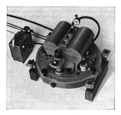
Fig. 1. Vollautomatische Reihenbild-Filmkammer R. C. 5 mit Statoskop
