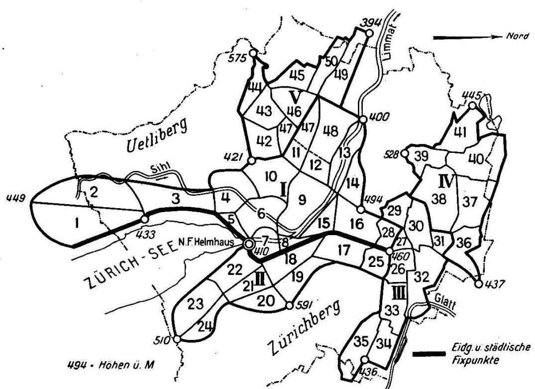
und mit den entsprechenden Gewichten in die Ausgleichung eingeführt wurden. Die Teilnetze III und IV sind mit Zwangsbedingungen an die Teilnetze I und II angeschlossen; bei Teilnetz V wurde in Anbetracht der Geringfügigkeit der Widersprüche auf die Aufstellung und Auflösung der Normalgleichungen verzichtet. Die 50 Schleifen des Nivellements wurden mit Gewichten nach der üblichen Formel
