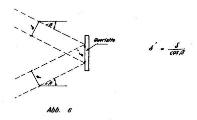
Wie aus der Abbildung 6 hervorgeht, wird bei geneigter Visur
