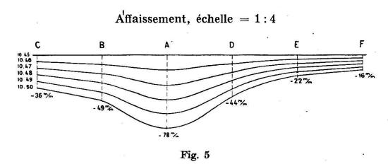
La figure ci-dessus montre exactement l'allongement que les affaissements peuvent produire sur les conduites souterraines, la nécessité de placer ou de déplacer les regards servant à l'évacuation des eaux, etc. S'il s'agit d'une voie ferrée, l'importance d'un contrôle régulier.
