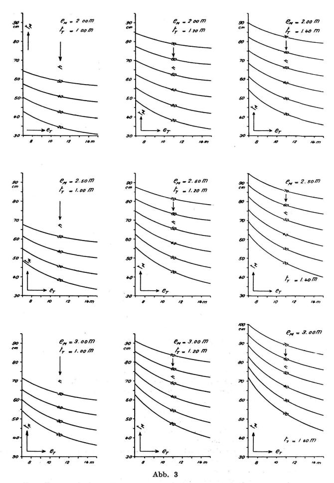
Darstellung äquivalenter Entwässerungstiefen  $t_M$  der Maulwurfsdrainage in Funktion der Draindistanz  $e_T$  der Tonrohrdrainage.
