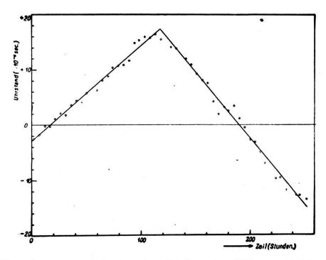
Bild 5. Gangsprung beim Standvergleich zweier S-Uhren mit Invarpendel
