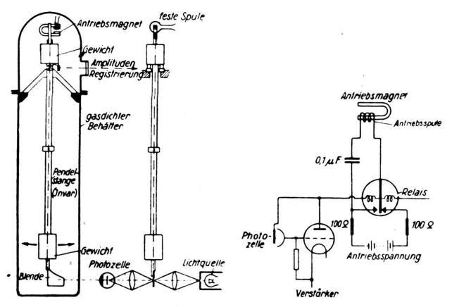
Bild 2. Ausgleichspendel mit durch Photozelle gesteuertem Antrieb
