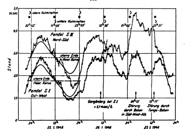
Bild 7. Uhrstand der Pendeluhren SI und SII gegen eine Rohde-Quarzuhr.
