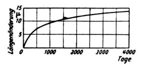
Bild 1. Zeitliche Längenänderungen eines Invarstabes von 1 m Länge nach Guillaume
