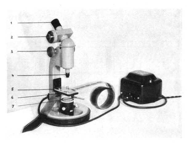
Fig. 2  $Film\text{-}Me\beta mikroskop\ mit\ 15\text{-}facher\ Vergrößerung}$
