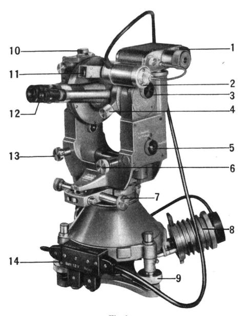
${\bf Fig.~1} \\ Pr\"{a}zisions the odolit~Wild~T~3~mit~aufgesetzter~Registrier kammer$
